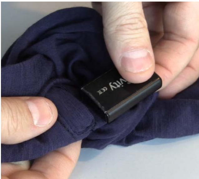
Figur 3. En accelerometer placeras i en ficka på ärmen.
