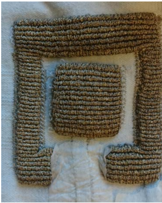
Figur 9. Elektroder stickade med ledande garn.
