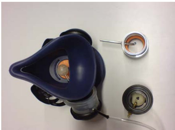
Bild 6. Olika adaptrar för mätning av partiklar innanför masken.
