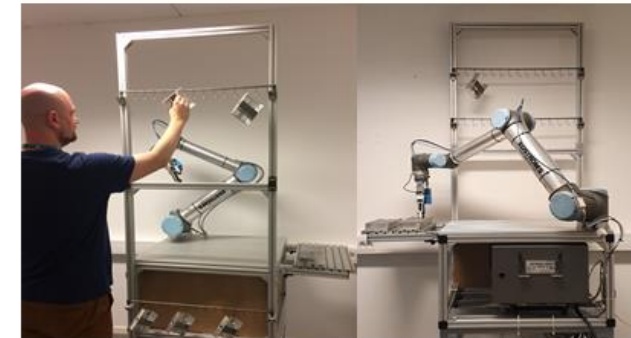
Test- och demo-utrustning för att utbilda och träna flera moment för att skapa hållbara, säkra arbetsplatser med kollaborativa applikationer med operatör och robot.
